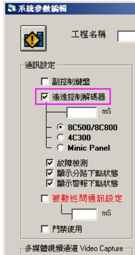
1. 登入 MEGAsys 系統後, 先行開啟 '遙遠控制解碼器及 8C500L/L2/SL/8C800L' 的通訊設定, 依序按下 [編輯系統參數] > [系統參數編輯] > [系統參數編輯]。
