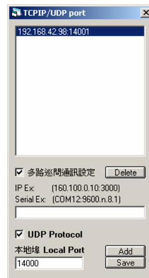
3. 視乎系統選用那種裝置, 選用合適的通訊口。例子: 選用 Ch.1 – DDC Com1: ET-Coder, 假設系統中接駁了 ET-8C500L/L2 報警收集器, 在 Ch1 旁邊點按一下, 如上圖。
