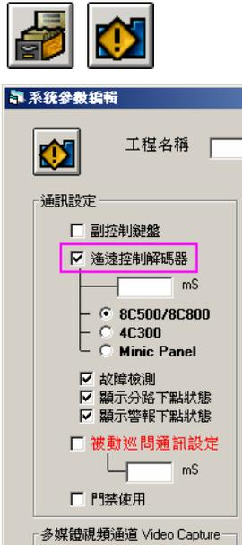
1. 登入 MEGAsys 系統後, 先行開啟 '遙遠控制解碼器及 8C500/8C800' 的通訊設定, 依序按下 [編輯系統參數] > [系統參數編輯] > [系統參數編輯]。
